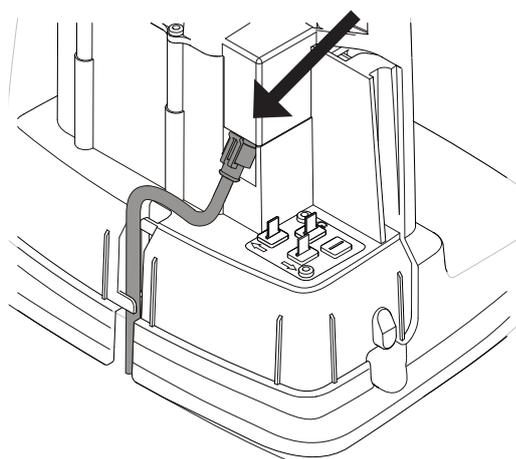
Podłączyć kabel niskonapięciowy do stacji ładowania.
