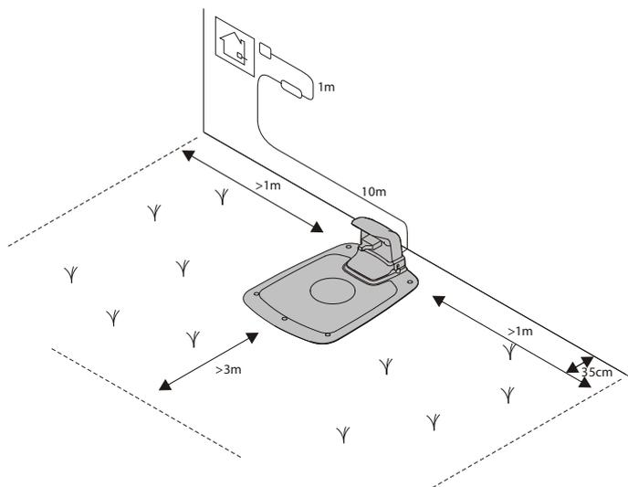
Poziționarea stației de încărcare după cum urmează:
