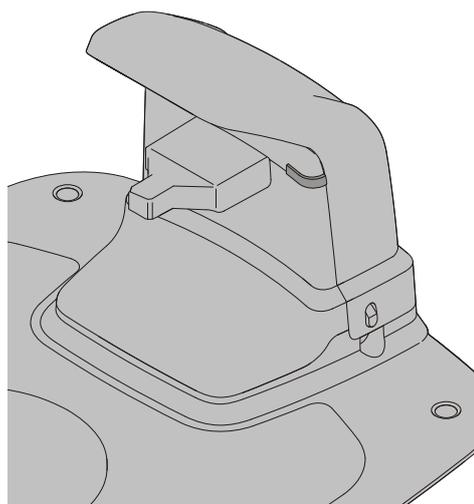
Připevněte nabíjecí stanici k zemi pomocí pěti dodaných upevňovacích šroubů s použitím 6mm imbusu.
