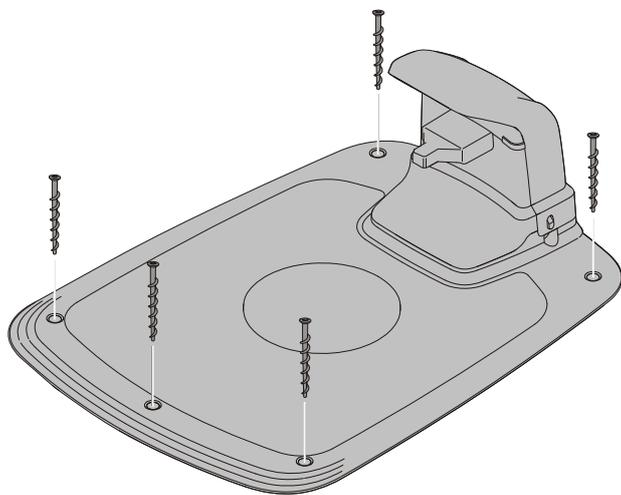
Fissare la stazione di ricarica al suolo con cinque viti di fissaggio fornito con una chiave esagonale 6 mm.
