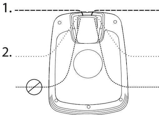
Suurimman osan latausasemasta on oltava työskentelyalueen sisäpuolella.
