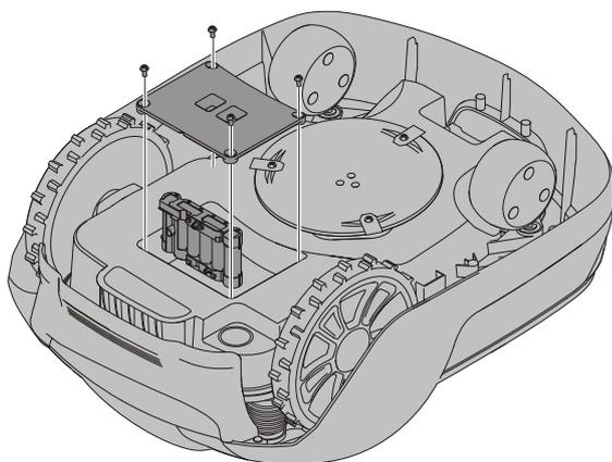
**VAROVANIE!** Stlačte tlačidlo STOP a pred výmenou batérií vyberte bezpečnostný kľúč a nasadte si ochranné rukavice.
