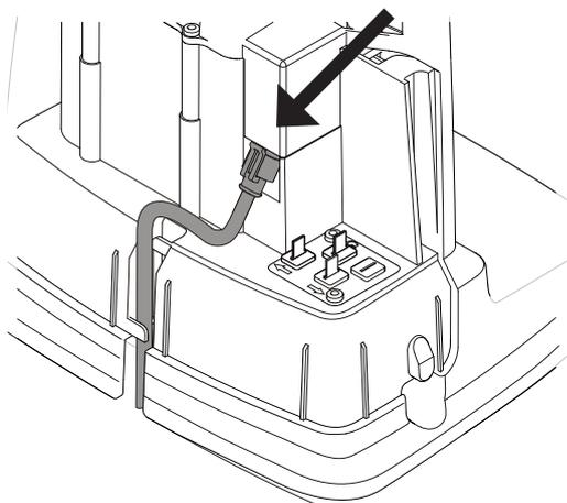
Conectați cablul de tensiune joasă la stația de încărcare.
