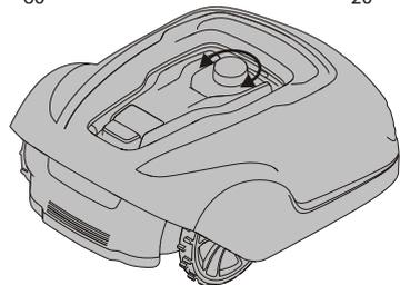
Durante las primeras semanas de corte, ajuste la altura de corte a 60 mm para evitar cortar el cable delimitador y el cable de guía. Posteriormente, baje el ajuste un paso cada semana hasta que se alcance la altura de corte deseada.
