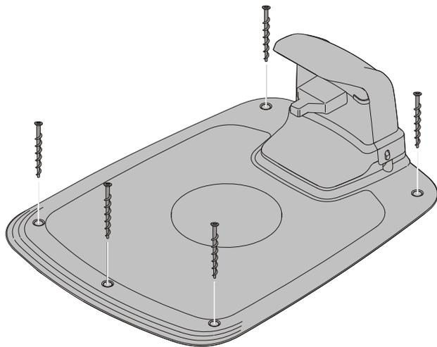
Шестигранным ключом на 6 мм закрепите зарядную станцию на земле пятью комплектными крепежными винтами.
