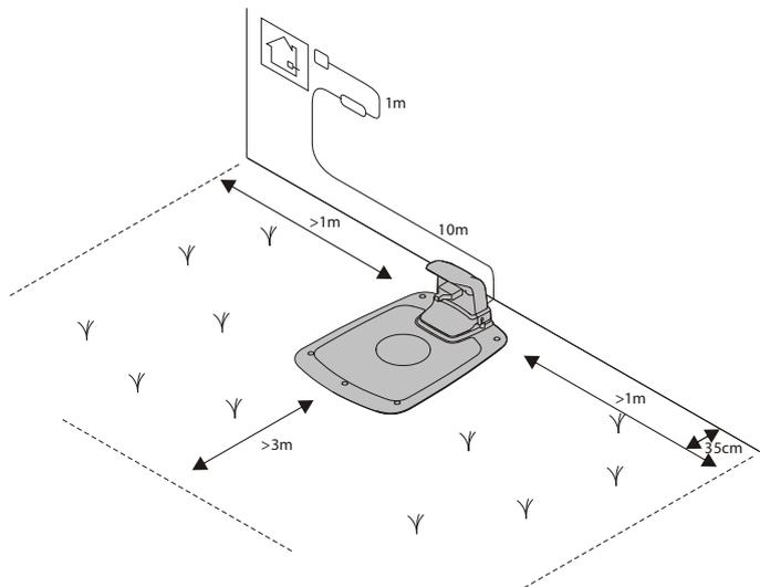
Stację ładowania należy ustawić w następujący sposób:
