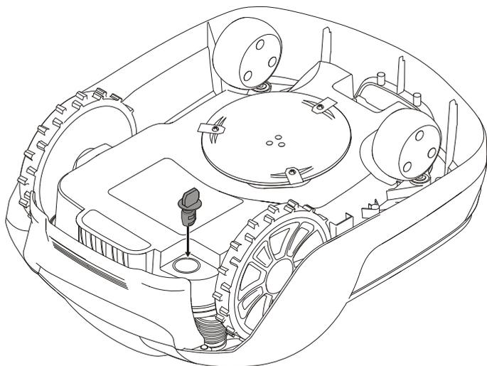
Inserire la chiave di sicurezza nella parte inferiore dell'apparecchio e ruotare la **Attiva**.
