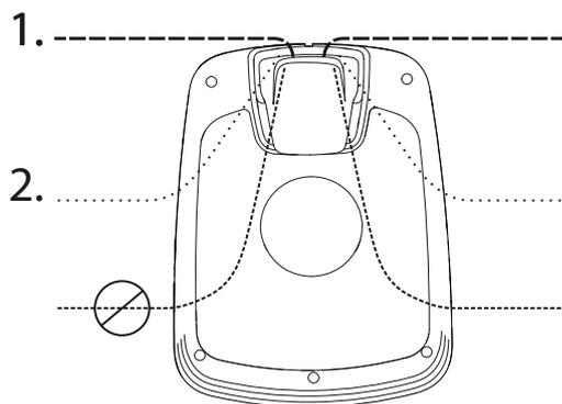
Suprafața majoritară a stației de încărcare trebuie situată în interiorul zonei de operare.
