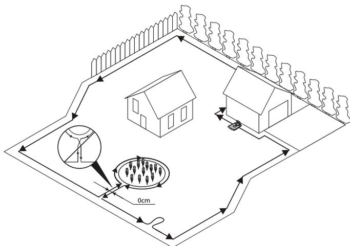
Временно закрепете края на контурния проводник към колчето или друг предмет при зарядното устройство.
