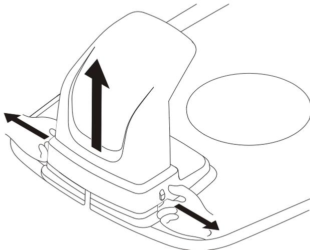
Ta av skyddskåpan på laddstationen genom att trycka på flikarna på vardera sidan av basen och lyfta av kåpan.
