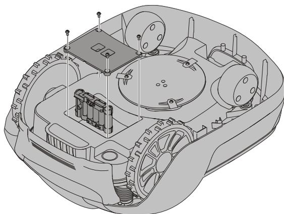
**UPOZORENJE!** Pritisnite gumb STOP i izvadite sigurnosni ključ prije zamjene baterija i nosite zaštitne rukavice.
