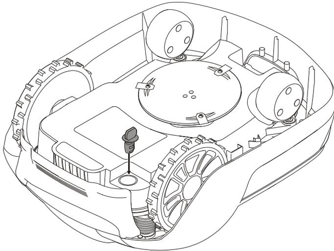
Stecken Sie den Sicherheitsschlüssel in die Unterseite des Mähers und drehen Sie ihn in die **aktivierte** Position.
