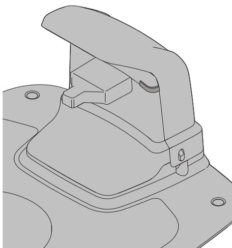
Controleer het led-controlelampje op het laadstation:
