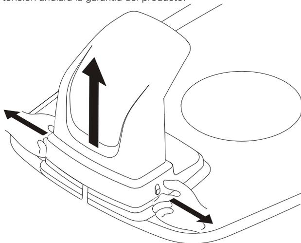
Retire la cubierta protectora de la estación de carga presionando las pestañas a cada lado de la base y levantando la cubierta.
