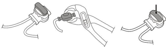
Se il cavo è troppo corto, gli usare filo di guida e splice connettori forniti per gli ulteriori splice il filo come indicato di seguito:
