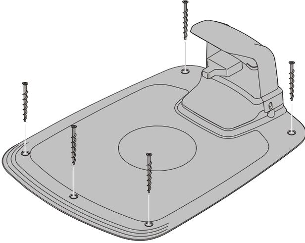
Kiinnitä latausasema maahan käyttäen viittä mukana toimitettua kiinnitysruuvia ja 6 mm:n kuusiokoloavainta.
