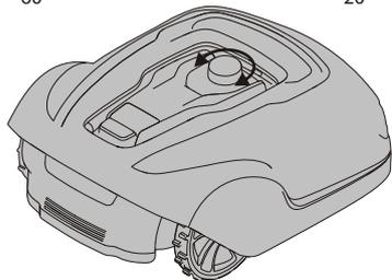
Během prvních několika týdnů sekání nastavte výšku sekání na 60 mm, aby nedošlo k přeřezání ohraničujícího drátu a vodícího drátu. Poté každý týden snižte nastavení o jeden krok, až dosáhnete požadované výšky sekání.
