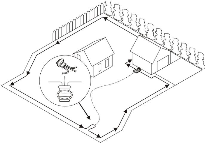
Косачката използва опционален направляващ проводник, за да открива своя път обратно към зарядното устройство, но и за откриване на трудно достъпни участъци на работната зона. Например, направляващият проводник се полага между зарядното устройство и отдалечена част на работната зона или през тесен проход.
