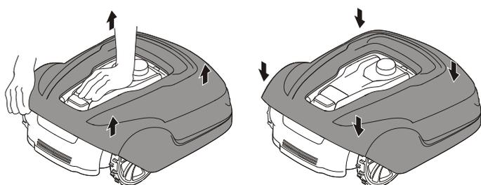
Чтобы снять корпус газонокосилки с шасси, удерживайте машину одной рукой, а второй поднимите корпус за один из углов; проделайте то же самое для всех четырех сторон.
