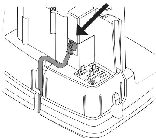
Zapojte nízkonapěťový kabel do nabíjecí stanice.
