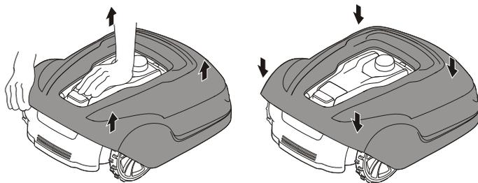
Hold gressklipperen nede med én hånd, og løft et av hjørnene på hoveddelen med en viss kraft. Gjenta dette for alle fire hjørner til hoveddelen spretter ut og løsner fra understellet.
