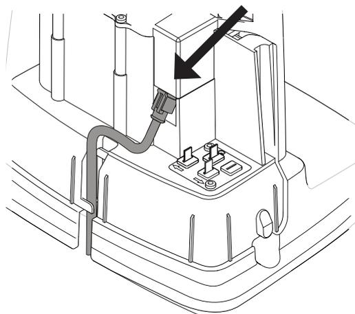
Sluit de laagspanningskabel aan op het laadstation.
