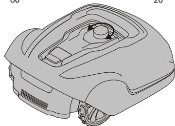
Para as primeiras semanas de corte, defina a altura de corte para 60 mm para evitar cortar o fio de delimitação e fio-guia. Reduza a configuração um passo a cada semana daí em diante até atingir a altura de corte desejada.
