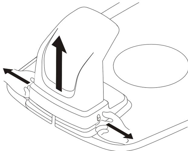
Verwijder de beschermkap op het laadstation door de lipjes aan weerskanten van de voet in te duwen en de kap vervolgens af te halen.
