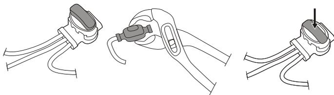
Utaknite oba kraja granične žice kao i kraj žice vodilice u spojnicu za upletke i žicu vodilicu. Provjerite jesu li žice do kraja umetnute u spojnicu za upletke i žicu vodilicu tako da se krajevi vide kroz spojnicu za upletke i žicu vodilicu.
