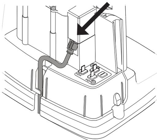
Entfernen Sie die Schutzabdeckung der Ladestation, indem Sie die Laschen auf jeder Seite der Basis eindrücken und die Abdeckung abnehmen.
