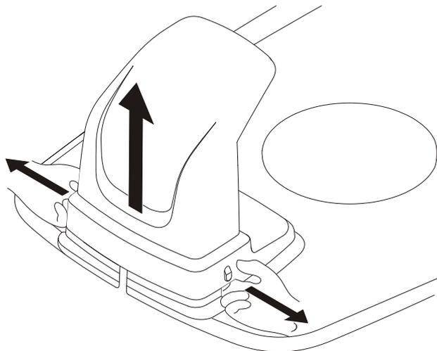
Rimuovere la copertura protettiva sulla stazione di ricarica premendo con i fermi su entrambi i lati della base e sollevare la copertura.
