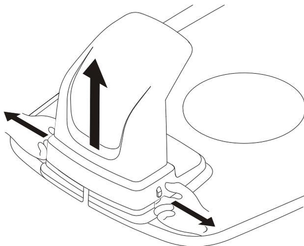
Odstraňte ochranný kryt na nabíjecí stanici stlačením úchytek na každé straně základny a odklopením víka.
